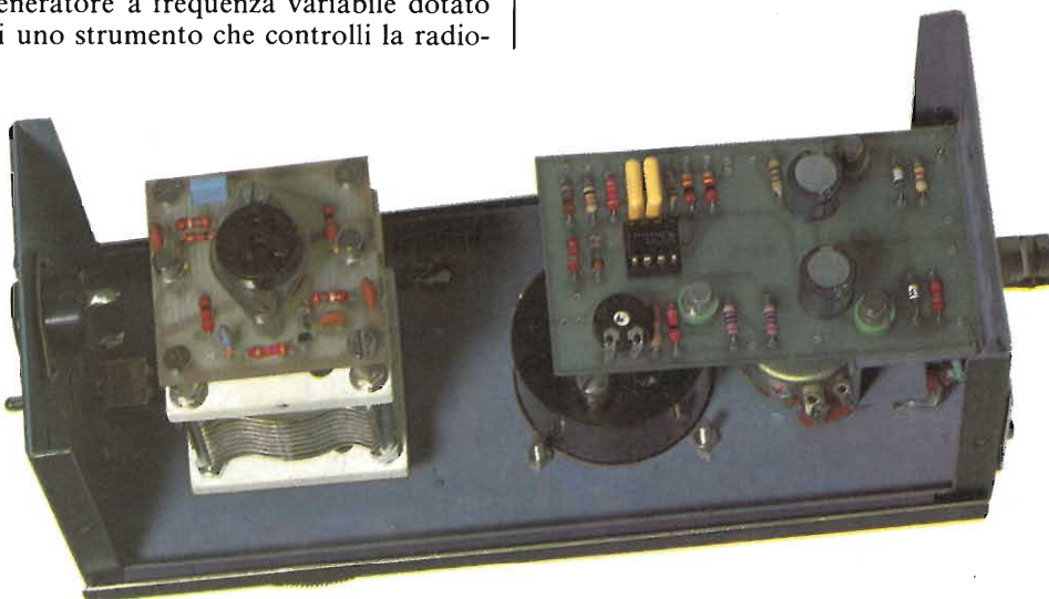
Interno dell'apparecchio, da notare il condensatore variabile a due sezioni fisse e una variabile.
