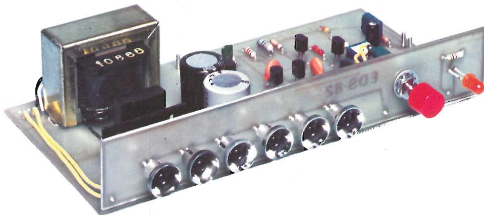
Sezione trasmettente del sistema ad infrarossi. I sei diodi fotoemittenti vanno dotati di minuscole parabole riflettenti per aumentare la portata.
