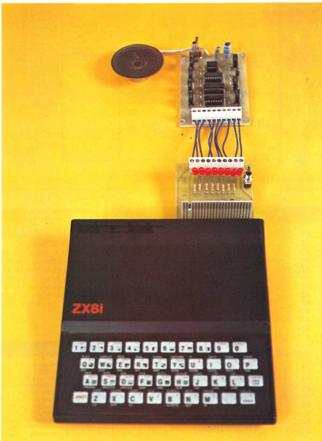
Scheda da interfaccia collegata al Sinclair ZX81: si noti l'inserimento della scheda nel computer ed il collegamento dell'espansione del bus MK-BZX.
