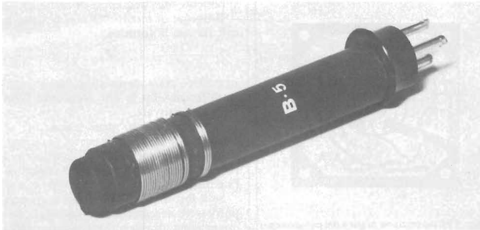
Bobina n. 5, si noti il link di 3 spire rispetto all'avvolgimento principale.
